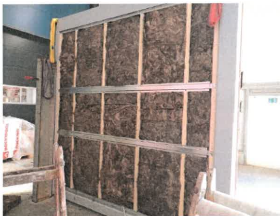
Bild A4.9 Ansicht der Gefachdämmung von der feuerabgewandten Seite.
