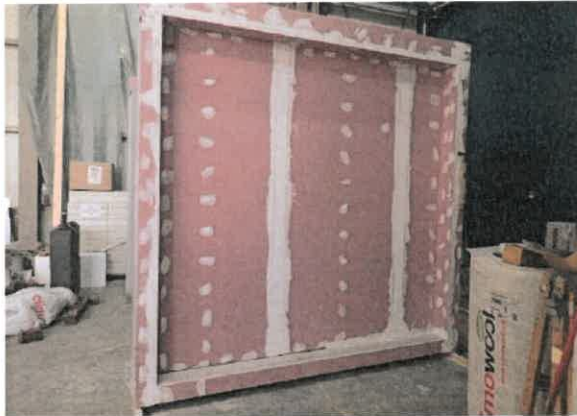
Bild A4.7 1. Bekleidungs- / Beplankungslage der feuerzugewandten Seite.
