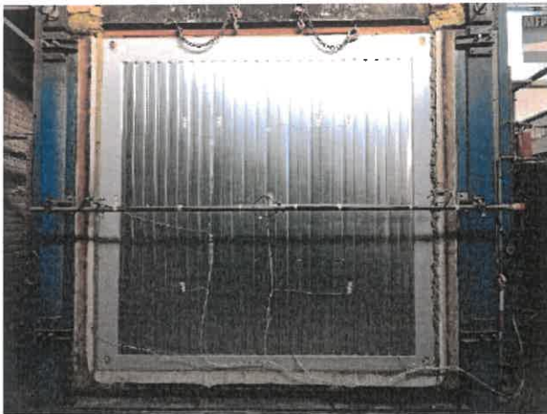
Bild A5.1 Ansicht der Containerwand von der brandabgewandten Seite vor dem Start der Feuerwiderstandsprüfung.
