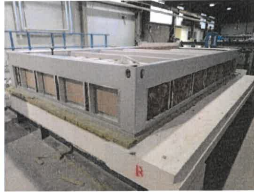
Bild A4.6 Ansicht der Dämmung der Wandstummel.
