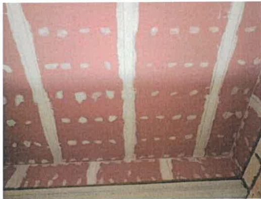
Bild A4.5 Ansicht der fertiggestellten Beplankung des Deckenmoduls von der feuerzugewandten Seite.
