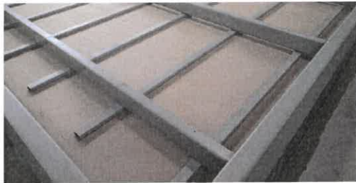
Bild A4.3 Ansicht der 1. Plattenlage des Deckenmoduls von der feuerabgewandten Seite.
