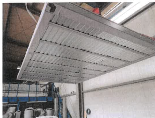
Bild A4.11 Ansicht des Bodenmoduls von der feuerzugewandten Seite.
