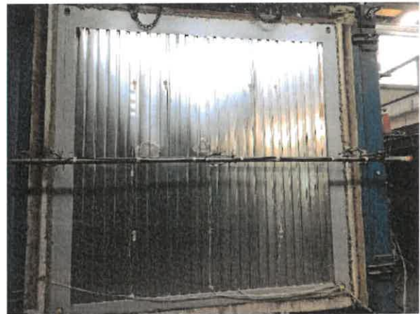
Bild A5.18 Prüfminute 69: Ende der Feuerwiderstandsprüfung in Absprache mit dem Auftraggeber.
