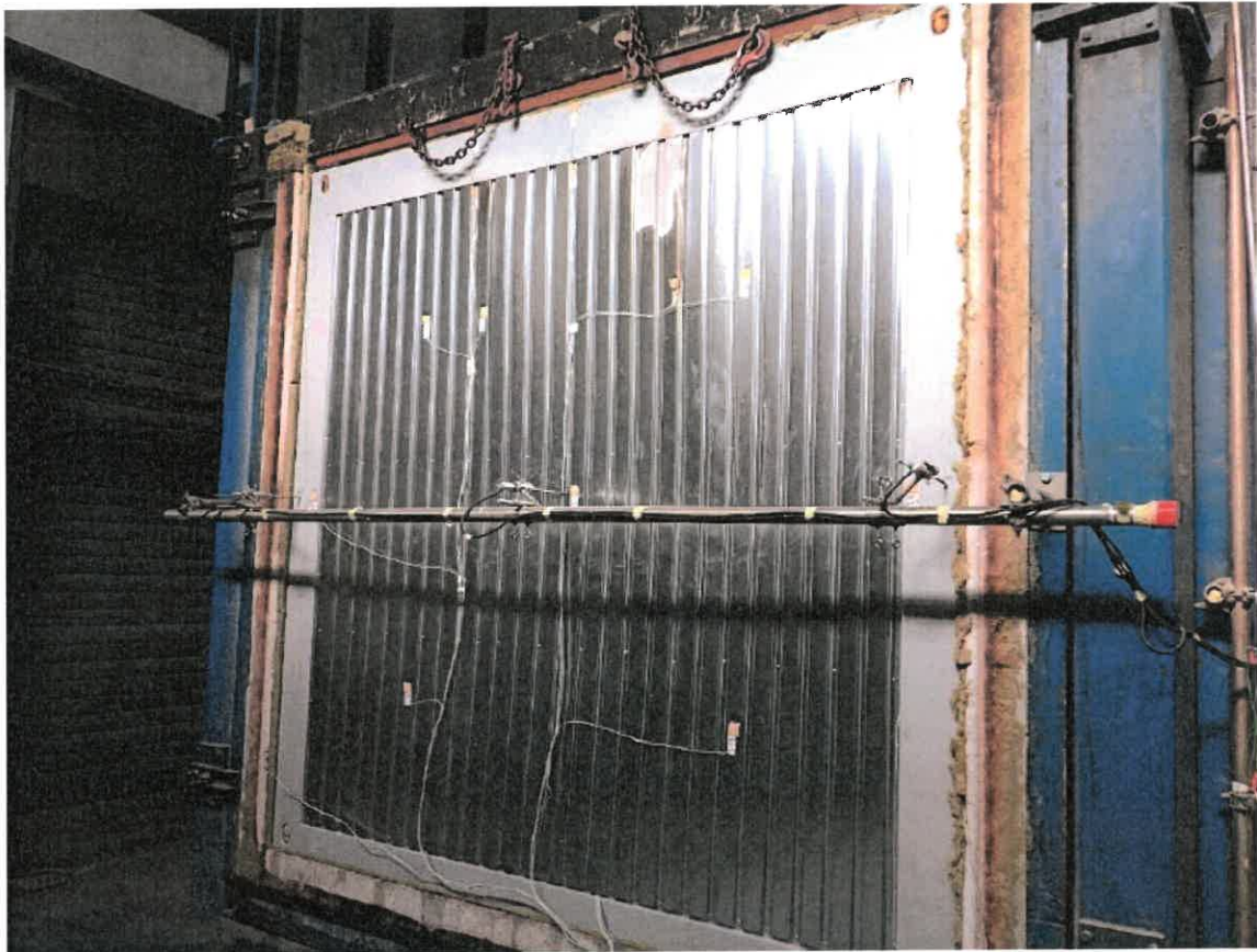
Bild A5.16 Prüfminute 64: Ende der Feuerwiderstandsprüfung in Absprache mit dem Auftraggeber.
