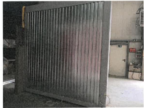
Bild A4.10 Fertiggestellte Bekleidung / Beplankung der feuerabgewandten Seite.
