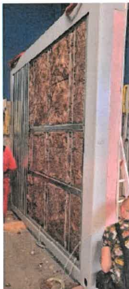
Bild A4.9 Ansicht der Gefachdämmung von der feuerabgewandten Seite.
