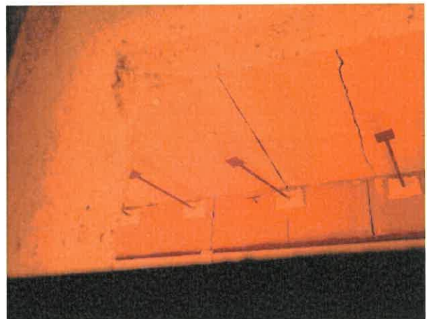
Bild A5.12 Prüfminute 28: Fugen und Längsrisse der großen Platten sind stabil.
