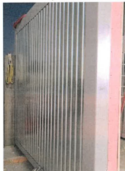
Bild A4.10 Fertiggestellte Bekleidung / Beplankung der feuerabgewandten Seite.
