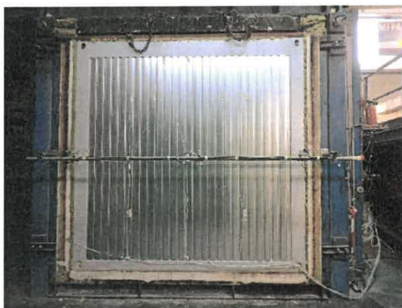
Bild A5.1 Ansicht der Containerwand von der brandabgewandten Seite vor dem Start der Feuerwiderstandsprüfung.
